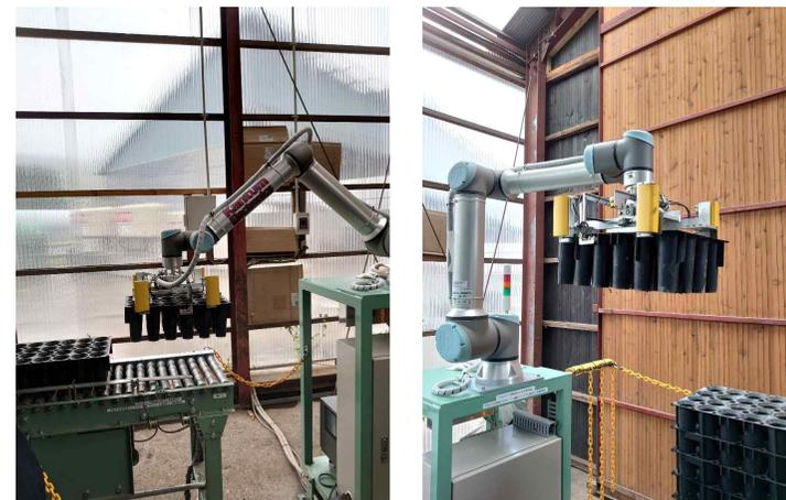
コンテナ苗生産において、単純作業であるコンテナに培土を入れる工程に、協働型ロボットアームを導入し機械化、労働負担を軽減した。また、機械化により発生した余剰人員を生産工程のボトルネックである移植作業に充当、作業期間を短縮した。
